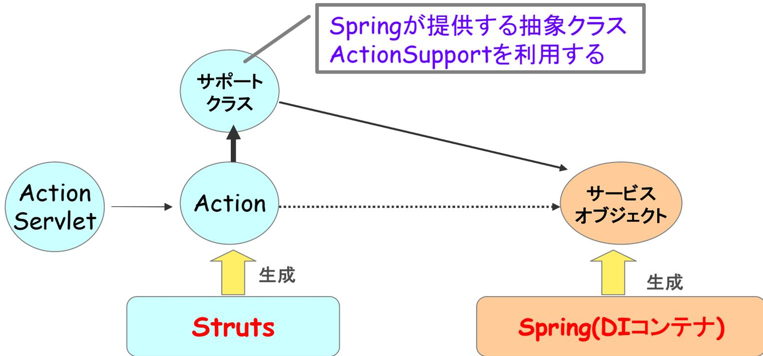
抽象クラスActionSupportはstrutsのActionを継承しているが、Springと連携する際にActionをサポートするメソッドを幾つか追加しているだけであることに注意したい。
